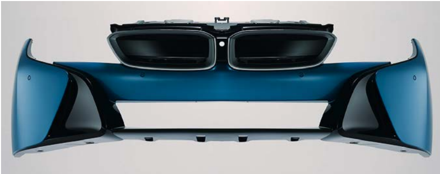
Bild 2. Der Front-Stoßfänger des Elektrosportwagens BMW i8 besteht aus dem Polypropylen Daplen EE112AE mit einer grundierungsfreien Lackierung (© Borealis)
